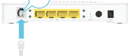
Inserisci una delle estremità del cavo ADSL nella porta ADSL del filtro doppio ADSL e l'altra estremità nella porta DSL del Modem.
