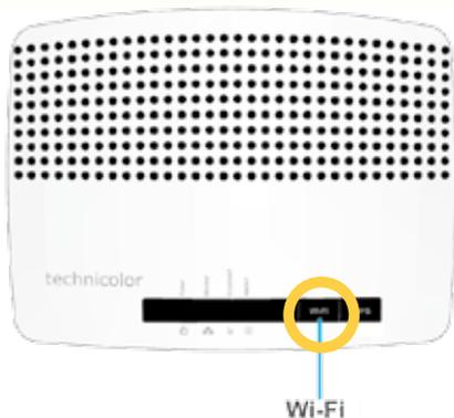
Per attivare il Wi-Fi del Modem premi l'apposito pulsante Wi-Fi e verifica che sul pulsante si accenda la spia verde. Il nome della rete Wi-Fi (Network name) e la chiave di cifratura (Wireless key) sono riportati sull'etichetta posta sotto il Modem.
